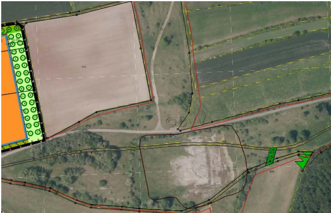
Abb.: Darstellung der geplanten Abschirmungsmaßnahmen Richtung Rauhenbühl: Zwischen dem Wanderweg am Trauf des Rauhenbühl (Blickbezüge durch grüne Dreiecke dargestellt) und geplanter PV-Anlage werden im Nahbereich eine Wildobstbaumreihe (externe Ausgleichsmaßnahme) und unmittelbar an der geplanten PV-Anlage eine Obstwiese (interne Ausgleichsmaßnahme) angelegt
